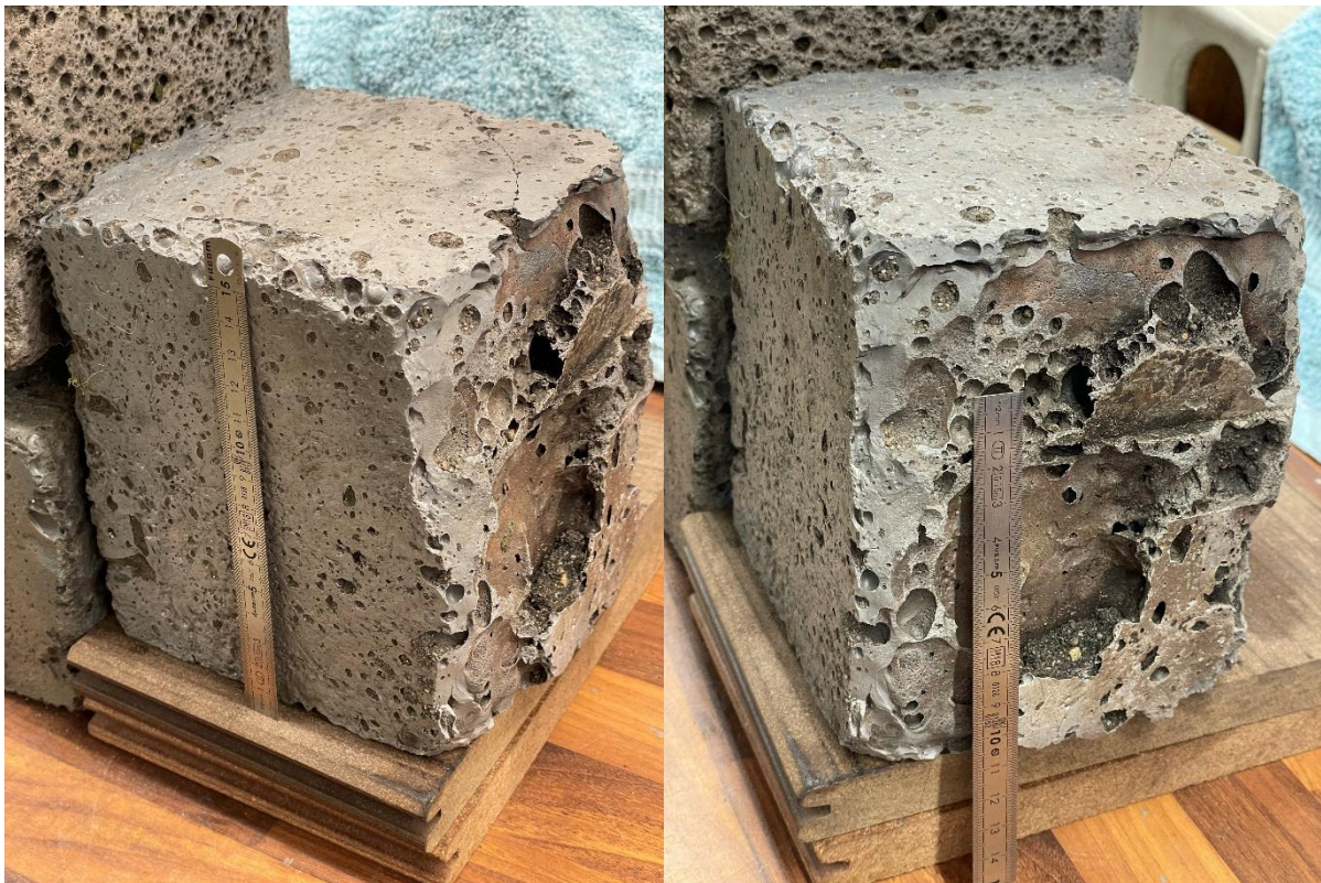
Schlackesteine, Seitenansicht und Unterseite mit Gaseinschlüssen aus dem Schlackeabguss
